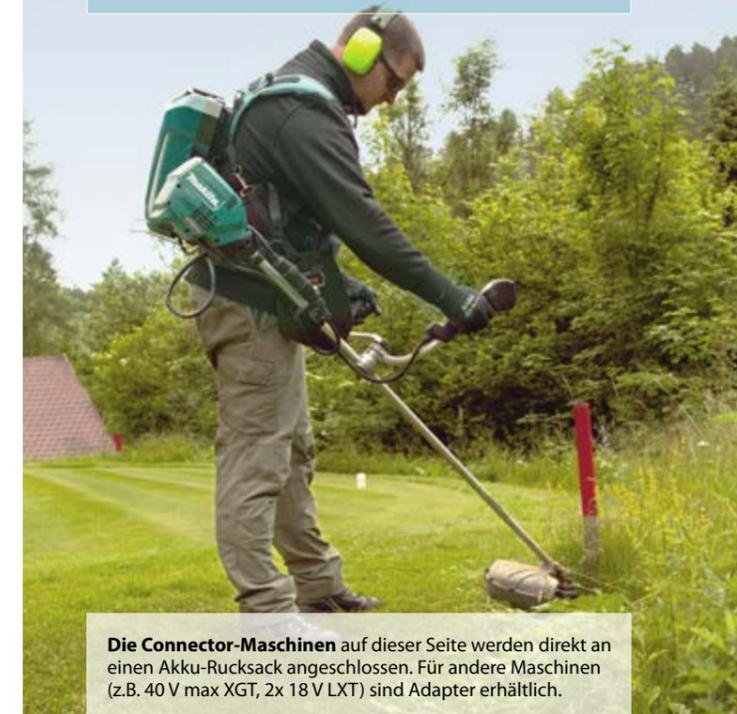
Die Connector-Maschinen auf dieser Seite werden direkt an einen Akku-Rucksack angeschlossen. Für andere Maschinen (z.B. 40 V max XGT, 2x 18 V LXT) sind Adapter erhältlich.
