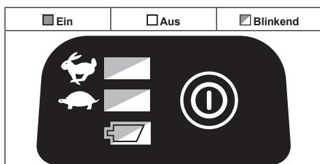
Falls das Werkzeug nicht startet, ist der Akku möglicherweise überhitzt. Lassen Sie den Akku in dieser Situation abkühlen, bevor Sie das Werkzeug wieder starten.
