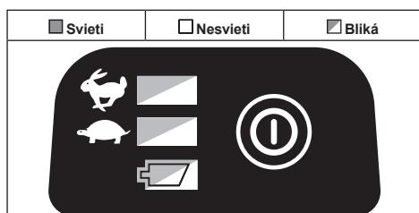
Ak sa náradie nespustí, akumulátor môže byť prehriaty. V takom prípade nechajte akumulátor pred opäťovným zapnutím náradia vychladnúť.
