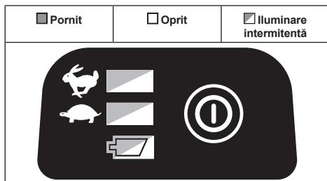
Dacă mașina nu pornește, acumulatorul poate fi supraîncălzit. În această situație, lăsați acumulatorul să se răcească înainte de a porni din nou mașina.
