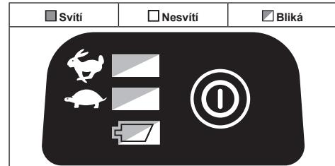
Jestliže se nářadí nespustí, mohlo dojít k přehřátí akumulátoru. V takovém případě nechte akumulátor před opětovným zapnutím nářadí vychladnout.
