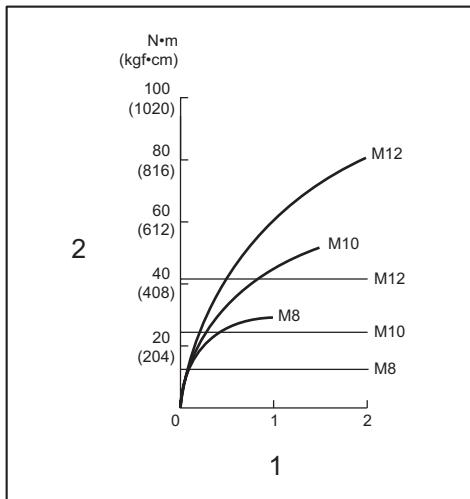
1. Czas dokręcania (s)      2. Moment dokręcania
