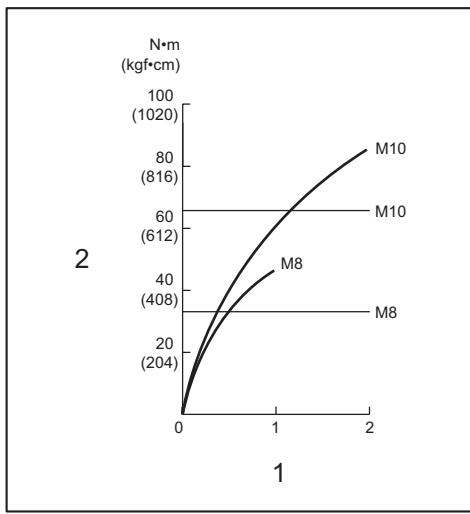
1. Czas dokręcania (s)      2. Moment dokręcania
