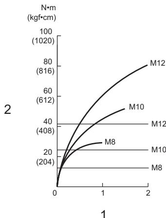
1. Час затягування (с) 2. Момент затягування
